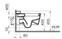
\*Duvar kalınlığına göre İlave boru gerekebilir \*Additional pipe may be required as to wall thickness
